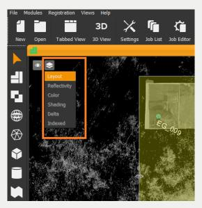
Wenn keine Option beim Erstellen eines Orthophotos ausgewählt wird, werden die Punkte im Orthophoto nach der Punktdichte mit Grauwerten verfärbt.
